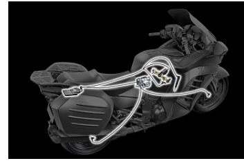
Kawasaki Traktionskontrollsystem (KTRC)
